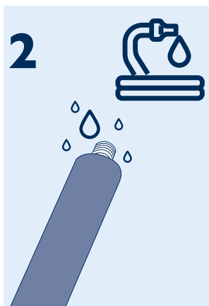
Lavare con acqua dolce e bollente per rimuovere la salsedine depositata internamente all'ingranaggio.
